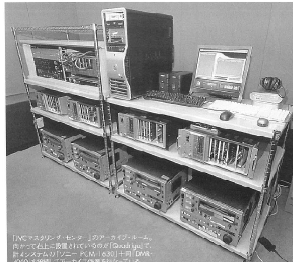
「JVCマスタリング・センター」のアーカイブ・ルーム。向かって右上に設置されているのが「Quadriga」で、計4システムの「ソニー PCM-1630」+同「DMR-4090」を接続してアーカイブ作業を行っている。
